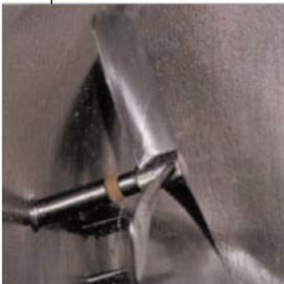
Ensamble de un agitador horizontal de tres aspas
