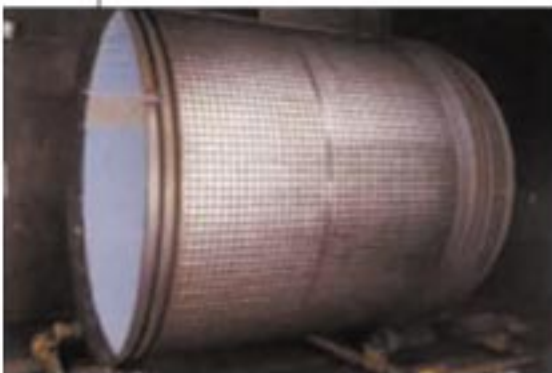
Pared refrigerada con cubierta avellanada
