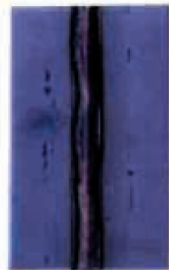
RECIÉN SOLDADO GTAW automática
